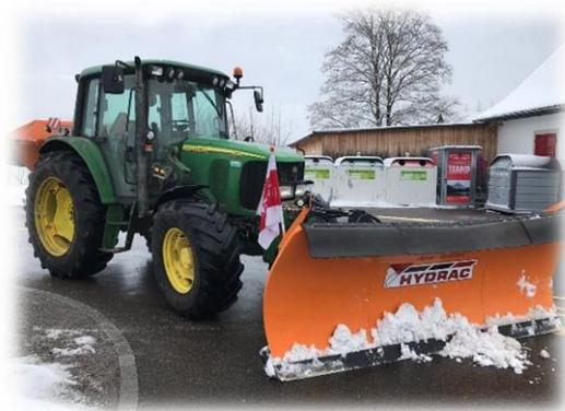
Abbildung 2: John Deere mit Pfadschlitten und Salzstreuer
